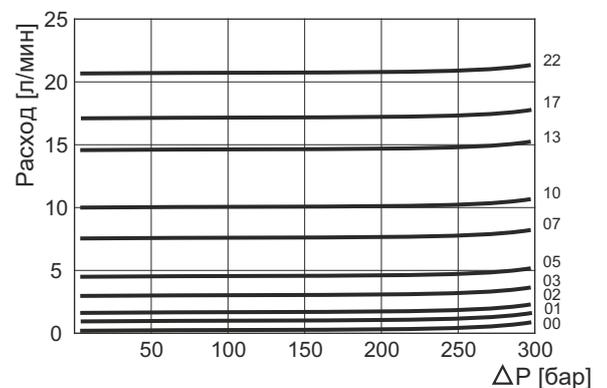
Примечание: номинальные регулируемые потоки, измеренные при 100 бар с вязкостью масла 46 сСт при 50 ° С, должны приниматься в качестве общих справочных значений и должны проверяться в полевых условиях.
