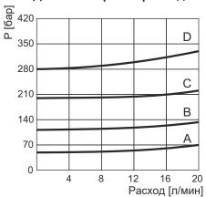
Примечание. Значения измерены только на клапане (без полости) с вязкостью масла 46 сСт при 50 ° С. Падение давления может меняться в зависимости от вязкости и температуры жидкости.
