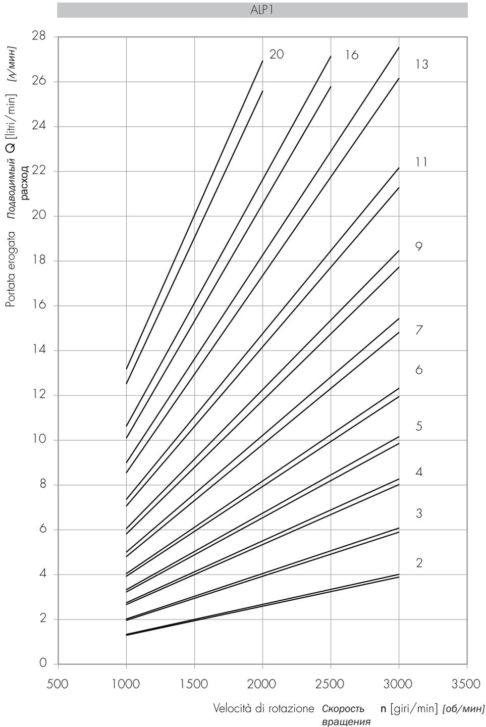
Le curve sono state ottenute alla temperatura di 50°C, utilizzando olio con viscosità 30 cSt alle pressioni sotto riportate.
