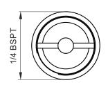
Клапан СУВ01 устанавливается в полость 9 центрального коллектора после его соответствующей обработки (сверления и нарезания резьбы). Функция этого клапана состоит в том, чтобы сбрасывать давление внутри центральной магистрали между насосом и обратным клапаном в полости 0, когда блок питания выключен. Обычно он используется при запуске однофазного двигателя под нагрузкой, преодолевая ограничения, присущие однофазным асинхронным двигателям переменного тока.
